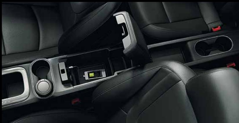
**Console centrale.** Elle possède à l'avant une sortie USB, une sortie stéréo auxiliaire et une prise 12 V pour vos smartphone et lecteur MP3, ainsi qu'un boîtier de rangement avec porte-gobelets. Les passagers arrière disposent eux aussi d'une prise 12 V et d'un casier de rangement muni de deux porte-gobelets. Retrouvez d'autres accessoires dédiés au confort de l'Ampera en p. 36/37.
